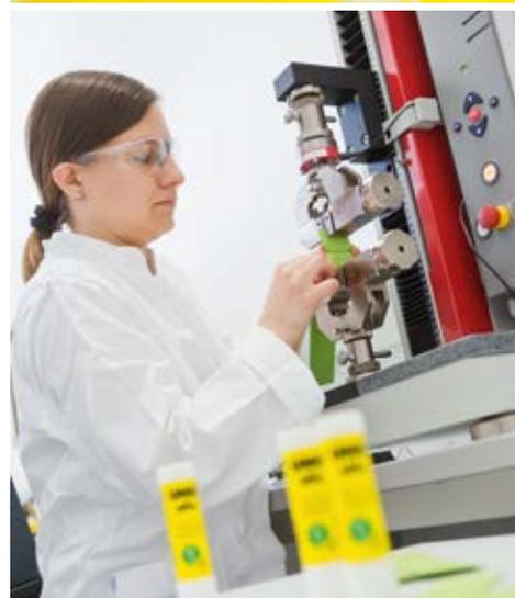
Links: Im Klimaprüfraum – mit definierter Temperatur und Luftfeuchtigkeit – werden die Klebstoffe auf ihre Klebeeigenschaften getestet. Hier zieht die Zugprüfmaschine verklebte Kartonagen langsam auseinander, bis das Papier reißt. Das ist gut und bedeutet, der Klebstoff ist stärker als das Papier. Und das spricht für die UHU Klebstoffe.
