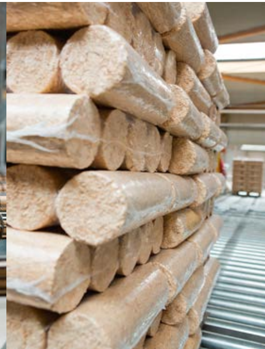
Fertig verpackt und gestapelt werden die Brikettpakete noch für die Transportsicherung eingeschweißt und dann ins Lager gebracht.
