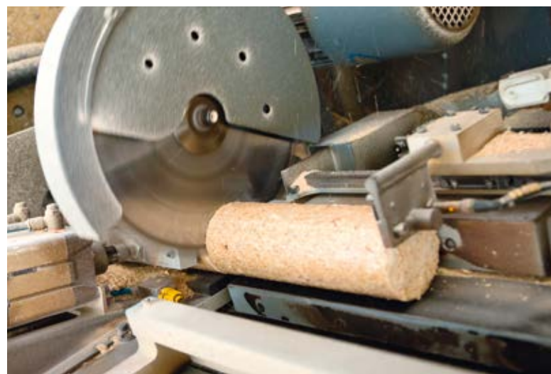
Der Brikettstab wird nach dem Abkühlen in etwa 30 Zentimeter lange, handliche Briketts zersägt.
