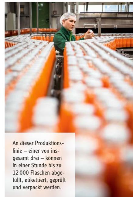
An dieser Produktionslinie – einer von insgesamt drei – können in einer Stunde bis zu 12 000 Flaschen abgefüllt, etikettiert, geprüft und verpackt werden.
