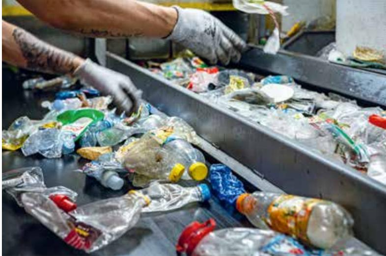
Trotz der modernen Maschinen wird zusätzlich von Hand sortiert, um einen Reinheitsgrad von 96 Prozent bei den Kunststoffarten zu erreichen.
