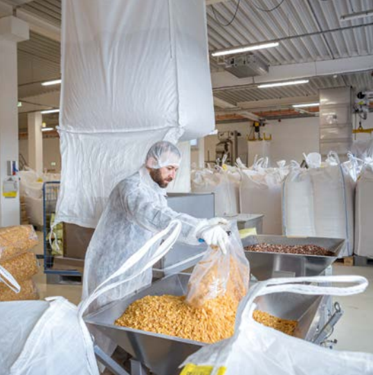
Auf dem sogenannten Mischboden werden Mehle, Müslis und Flakes zusammengesiebt und in die Abpackanlage weitergeleitet.
